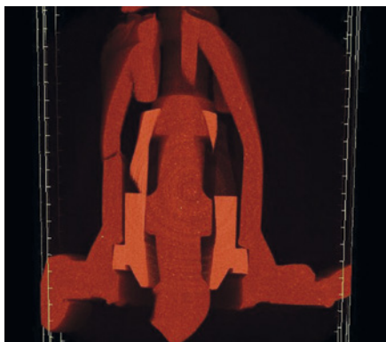
Řez poškozenou bezpečnostní plombou
